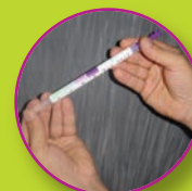
• Après 10 minutes, comparaison de la couleur obtenue par rapport à l'échelle colorée intégrée sur le tube.
