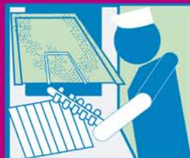
Démonter et nettoyer bras de lavage, jets de rinçage et rideaux de séparation
