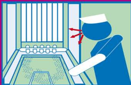
Contrôle de propreté et de mise en place des bras de lavage, des jets de rinçage et des rideaux de séparation
